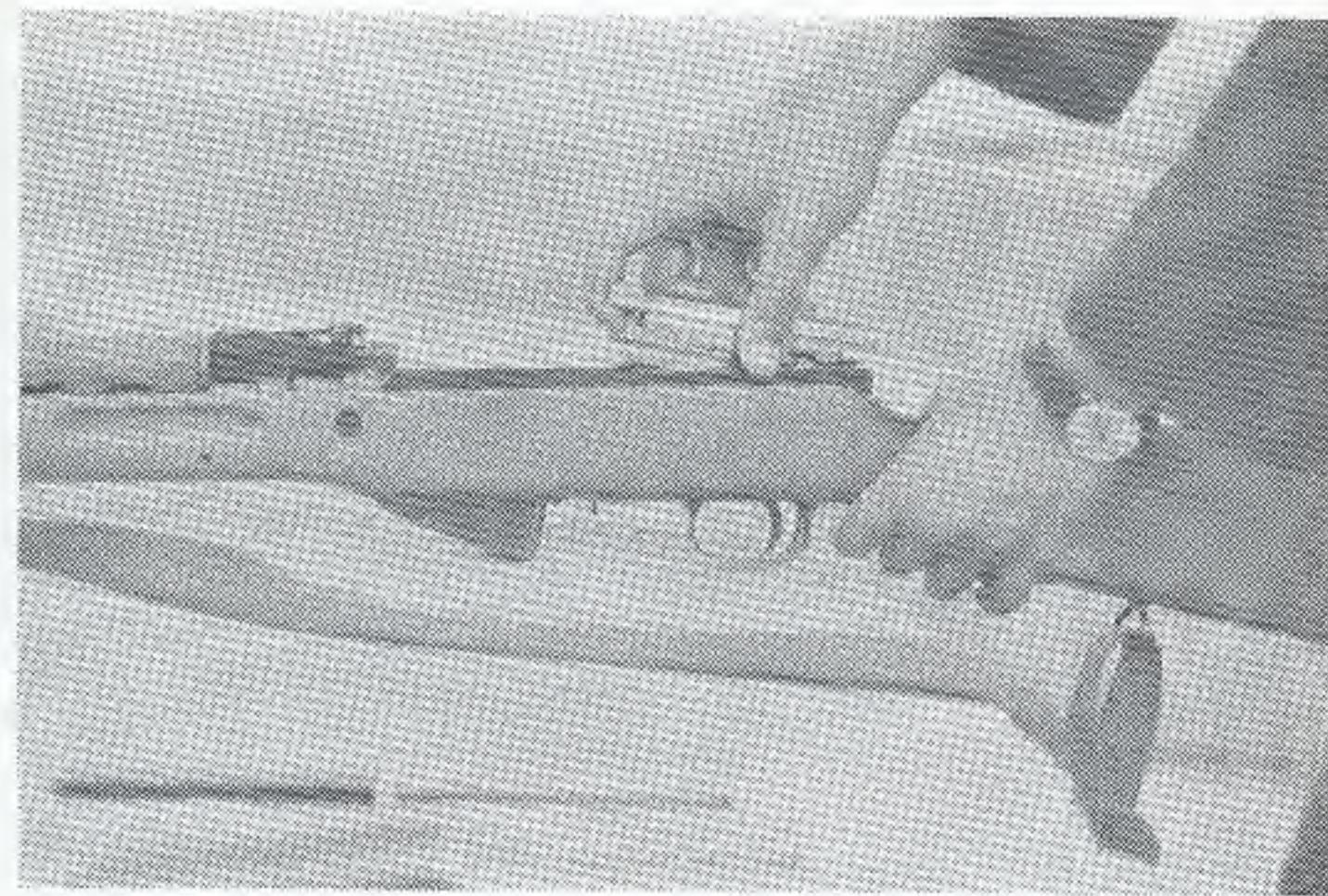
Sl. 22 – Vađenje nosača zatvarača sa zatvaračem
